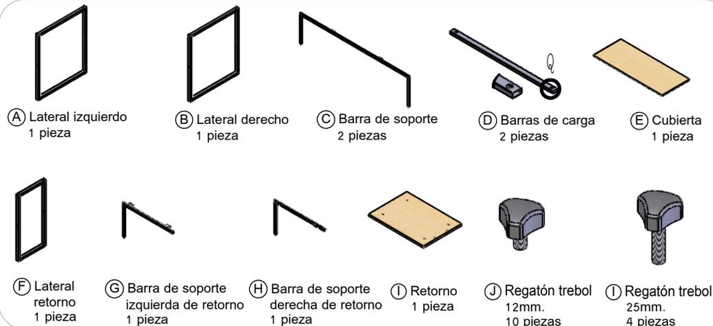
Colocar las cubiertas (E) (I) sobre barras de carga y sobre escuadras de retorno, asegurarla con regatón de 25mm (K) en barras y con regatón de 12mm (J) en escuadras.
