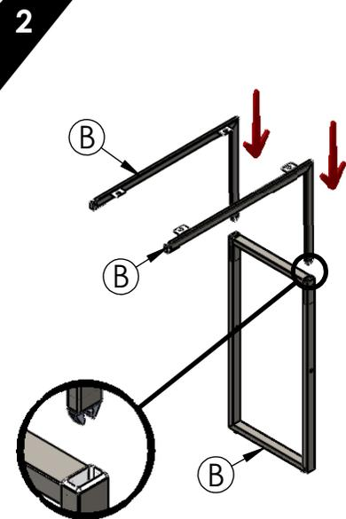
Deslizar las barras de soporte de retorno (B) dentro de los bujes del lateral del retorno (B) hasta que se escuche un "click".
