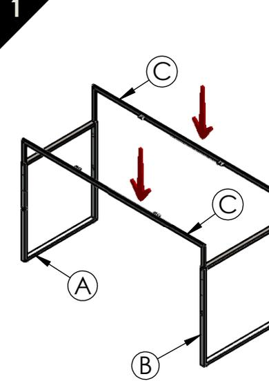
Deslizar las barras (C) de soporte a través de los bujes de los laterales (A) (B) hasta que se escuche un "click". Las barras deben entrar derechas.
