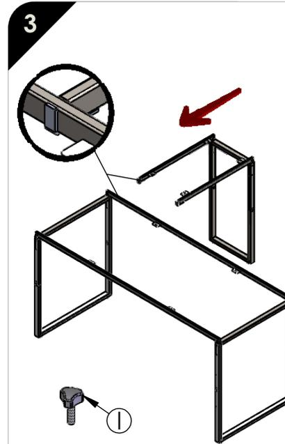
Insertar los soportes del retorno a la barra de soporte y unir con regaton trebol de 25mm (K).
