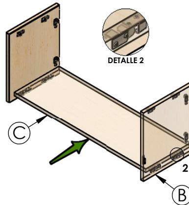
**Deslizar fondo hacia arriba para ensamblar macho/hembra con laterales 3**
