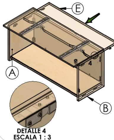
**Colocar soportes en la parte trasera del fondo y asegurar ajustando tornillos conectores con la llave allen 5**
