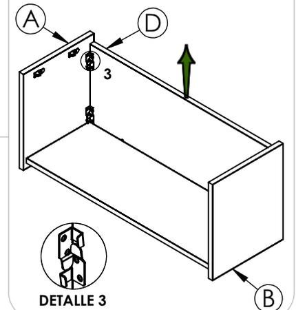
**Colocar cubierta sobre laterales para ensamblar macho/hembra 4**
