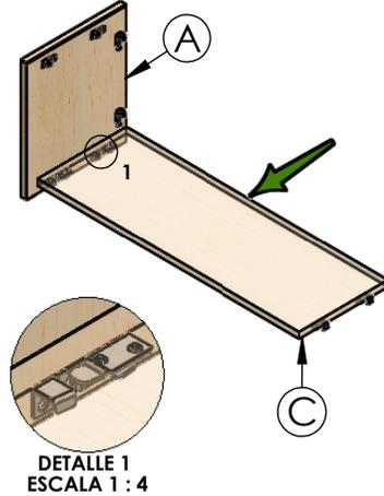
**Deslizar lateral derecho sobre repisa para ensamblar macho/hembra 2**
