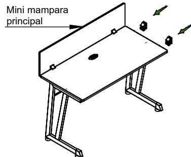
Ajustar el soporte (aflojar el regatón de 23mm) para dar la abertura que sea acorde al espesor de la mampara **2**
