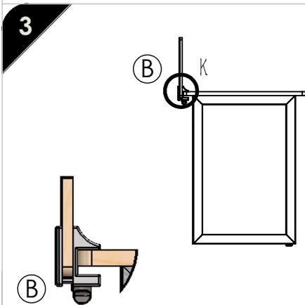
Ajustar los soportes (B) a la cubierta con los regatones (B).
